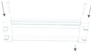
Solidariser l'ensemble avec les clavettes, enfoncées de force au marteau.
